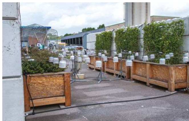
Expérimentation menée au centre INRAE de Montpellier visant à atténuer les îlots de chaleur urbains par une irrigation optimale de la végétation.
