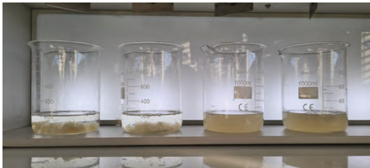
Résultats d'essais de coagulation-floculation selon des concentrations de produits différentes.
